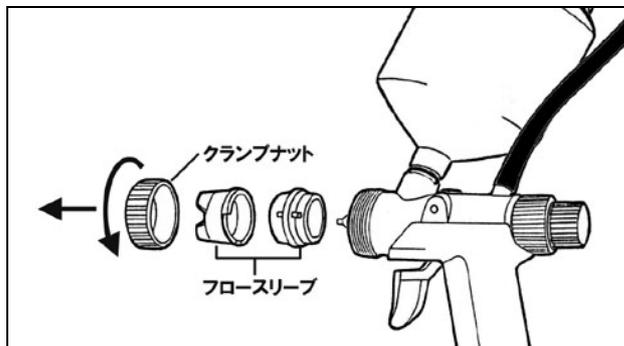
①塗料カップ内に塗料が無いことを確認して、ガン先端のクランプナットを緩め、フロースリーブを外します。
